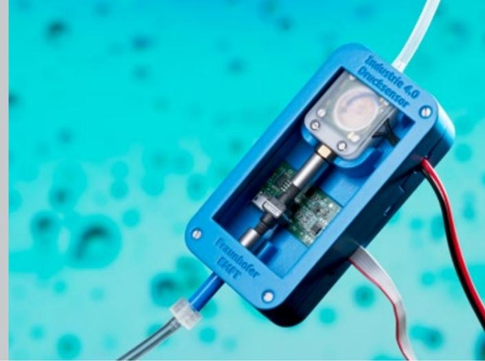
*Innovativer Mikro-Flusssensor in Verbindung mit Mikropumpe für verteilte Gassensorik im Bereich der Industrie 4.0*
