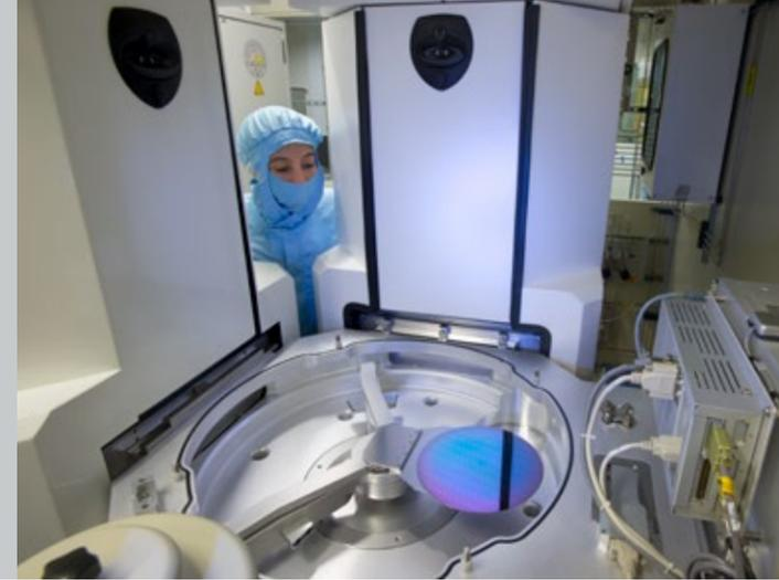
*Thermisch unterstützte chemische Gasphasenabscheidung auf 8-Zoll-Wafer*
