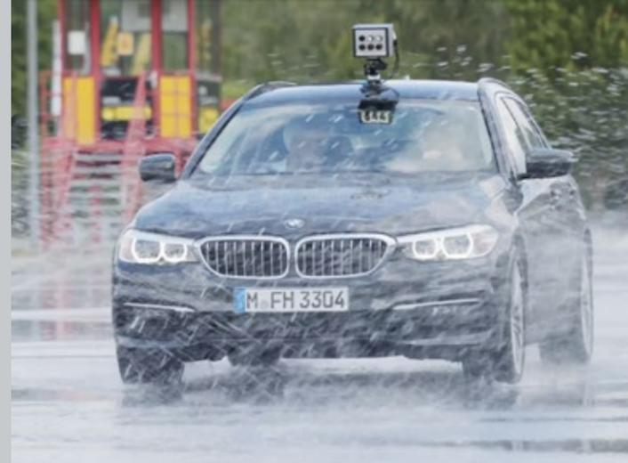
Ursprünglicher Prototyp des Frühwarnsystems zur Erkennung von Aquaplaning und Glatteis im Test
