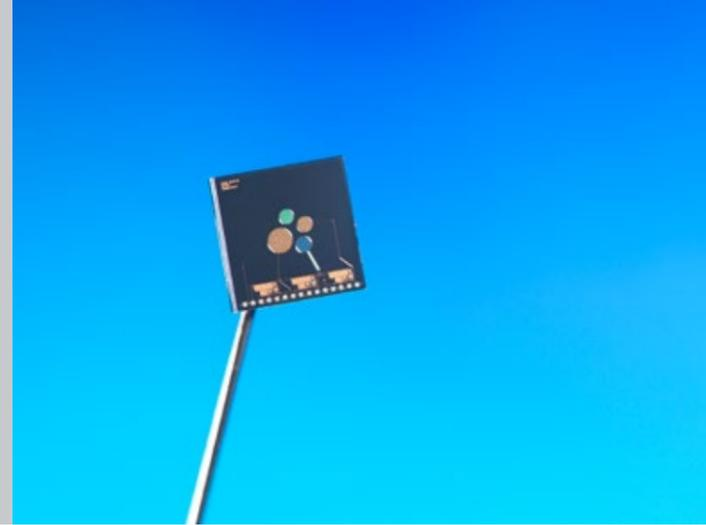
CMOS Ionensensitiver Feldeffekttransistor mit kontrollierbarem Floating Gate (FG-ISFET)
