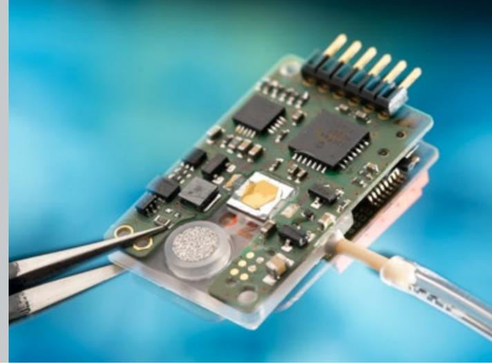
Prototyp eines auf dem kapazitiven Messprinzip basierenden Feinstaubpartikelsensors für die Messung von PM10, PM2.5 und PM1.0 Partikeln. Es besteht aus einem Fluidik-Modul inklusive Filter, Micro-Pumpe und Fluidikkanal zur Aerosol Zufuhr und aus dem Sensormodul zur Detektion der Partikel.
