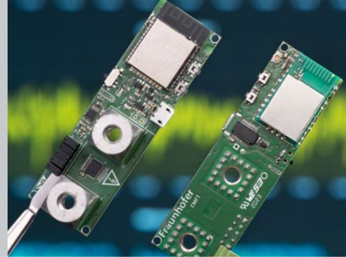
Miniaturisiertes, hall-basiertes Stromsensormodul
