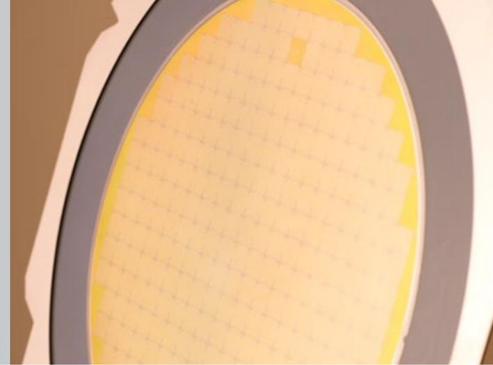
8" Siliziumwafer mit low-noise Varaktordioden
